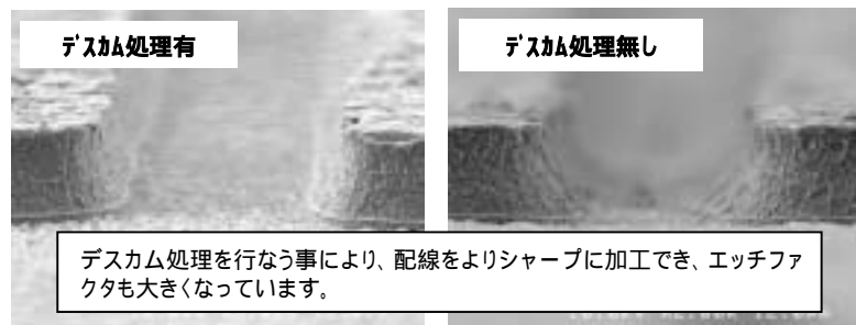
図2 デスカム処理の効果(SEM断面写真)
