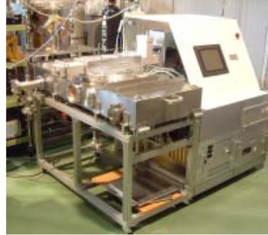
図1 プラズマ表面処理装置
